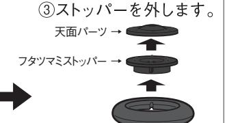
※ 天面パーツを外して洗浄できます。下図のようにスプーン等を差し込み、取り外してください。
