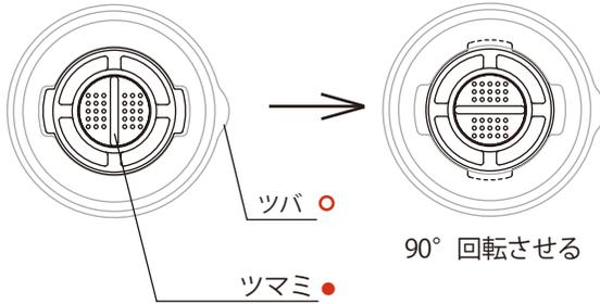
注ぎ口淵にあるツバを右にして、フィルターツマミを縦方向にし注ぎ口溝にフィルターの突起部を合わせてセットし、ツマミを90度回します。フィルターがしっかりセットされたか確認してください。
