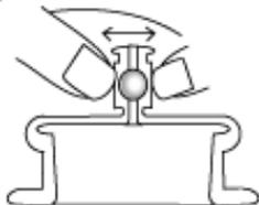
②それでも点滴しない場合はゴム弁の穴に箸等の先端の丸い棒を入れて金属球を押し、金属球とゴム弁の密着を解消してください。
